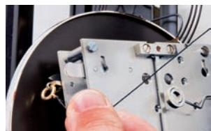
Das Uhrwerk muss herausgenommen werden, um später das Pendel einzusetzen.
